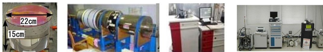
図1: サファイア鏡、残留磁化 SQUID、磁気特性 MPMS 装置、物理特性測定(PPMS)装置 (装置は全て富山大所有)。
